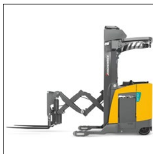
Pantógrafo para apilado de doble profundidad
