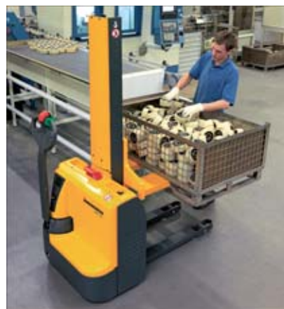
Aplicación como mesa de elevación
