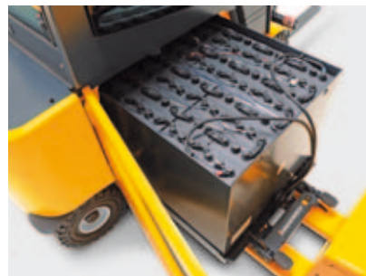
Cambio de batería mediante SnapFit
